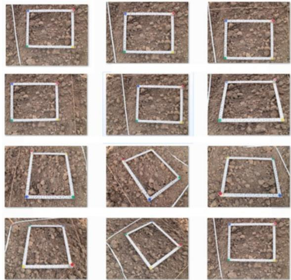
**Figure 9 :** Série de 12 photos prises sous différents angles utilisées pour calculer le modèle 3D de la placette (Figure 6)
