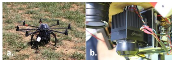
Figure 2 : Système d'acquisition d'images aériennes.
