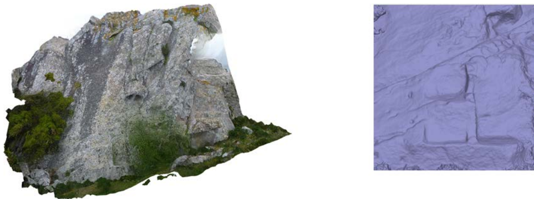
Figure 7 : La couverture photogrammétrique d'une falaise de la Silla del Papa, Espagne (à gauche) a permis la génération d'un modèle 3D où sont clairement visibles les aménagements anthropiques réalisés sur cette falaise pour l'installation de bâtiments (à droite).
