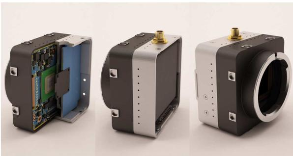
**Figure 7** : vue en images de synthèse de l'association étage imageur-module batterie, sans optique
