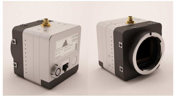
**Figure 8** : vue en images de synthèse de la configuration laboratoire (association étage imageur-module batterie-module interface), sans optique
