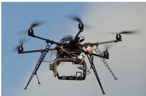
**Figure 1** : hexacopteur de la société Mikrokopter utilisé à l'IGN
