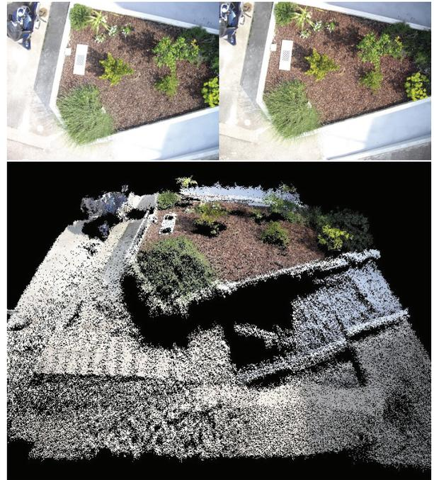
**FIGURE 9:** Exemple de couple stéréoscopique acquis avec le capteur tri-caméras et la restitution tridimensionnelle obtenue.
