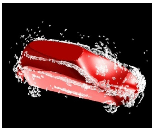
Complétion 3D génération des surfaces à partir du nuage de points lacunaire
