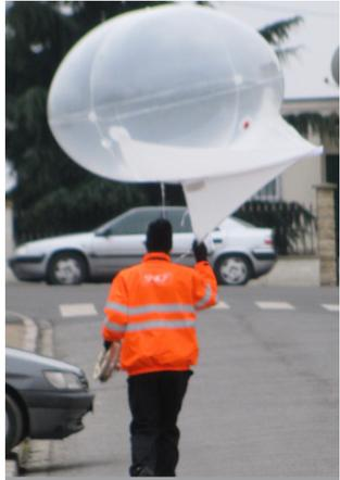
**Helikite** Charge utile 1kg. Contexte vent 0 à 4 Bft (0 à 24km/h)
